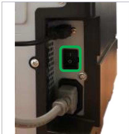
Allumez l'imprimante à l'aide de l'interrupteur situé à l'arrière.
