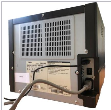
Connectez le câble d'alimentation et le câble USB à l'arrière de l'imprimante.
